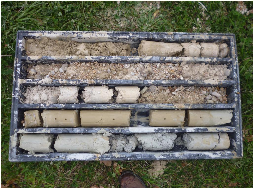
Foto n°9 – Sondaggio n°12: Cassetta n°2 da -5.00 a -10.00 m
