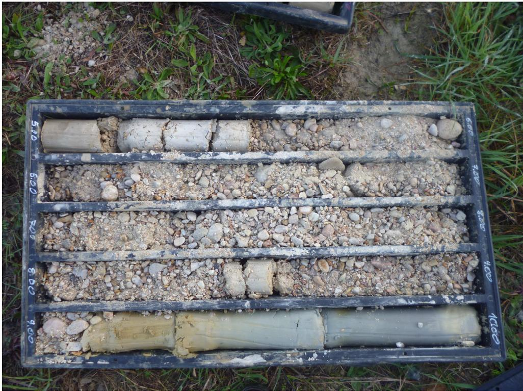
**Foto n°3** – Sondaggio n°10: Cassetta n°2 da -5.00 a -10.00 m
