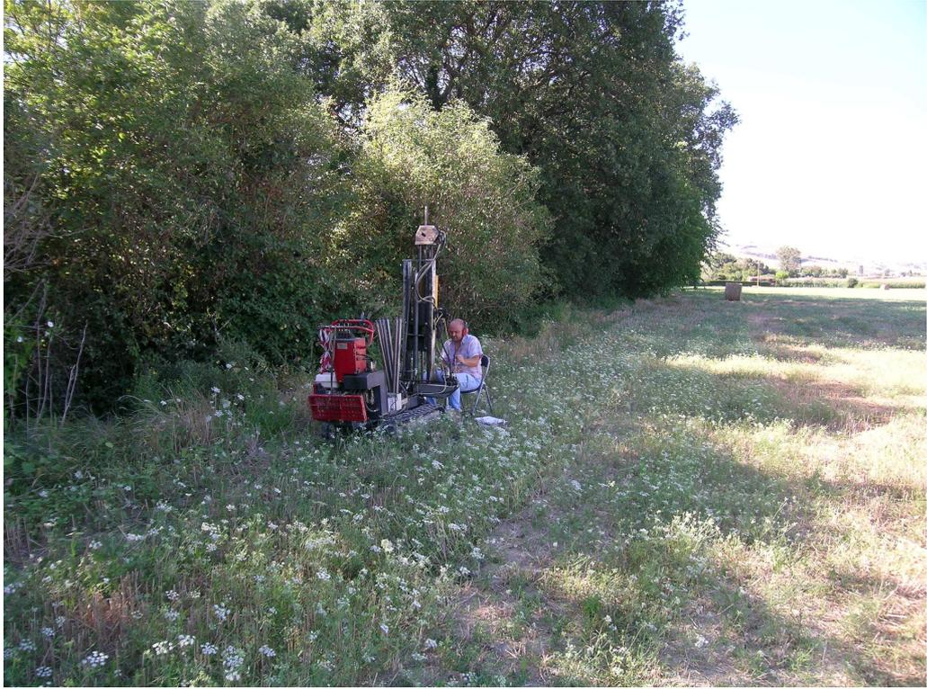
**Foto n°47** - Postazione Prova penetrometrica dinamica n°2
