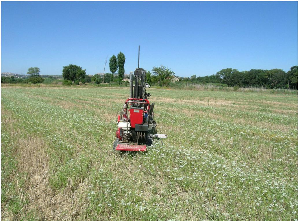
**Foto n°48** - Postazione Prova penetrometrica dinamica n°3
