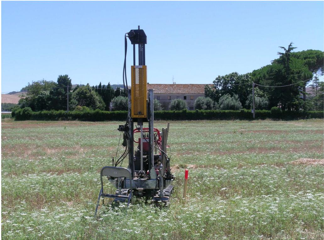
**Foto n°49** - Postazione Prova penetrometrica dinamica n°6
