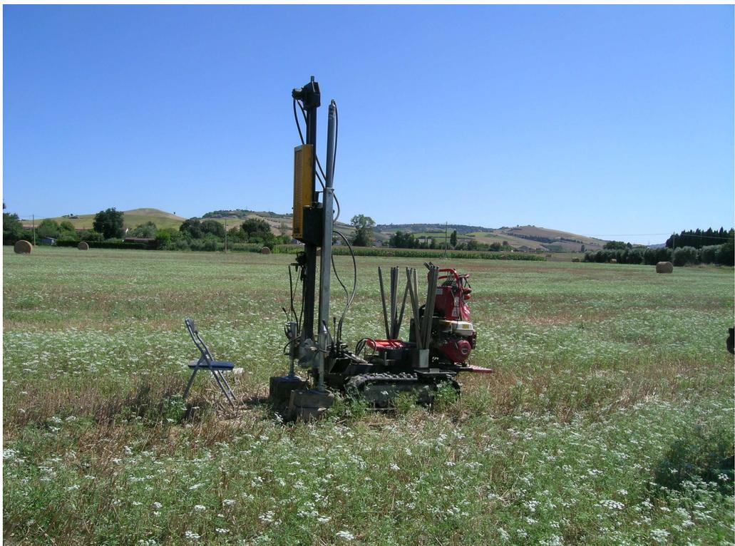
**Foto n°50** - Postazione Prova penetrometrica dinamica n°5
