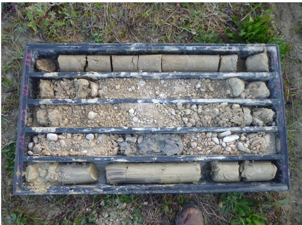
**Foto n°2 -** Sondaggio n°10: Cassetta n°1 da 0.00 a -5.00 m
