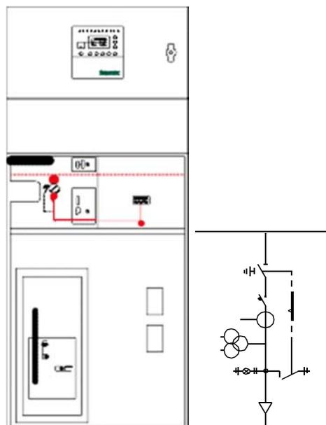
**Cella di protezione generale da installare nella cabina MT esistente a protezione generale del nuovo quadro MT**
