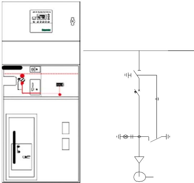
**N.2 cella di protezione Quadri MT, N.1 per la nuova cabina MT-02 e N.1 per la cabina esistente MT-01**
