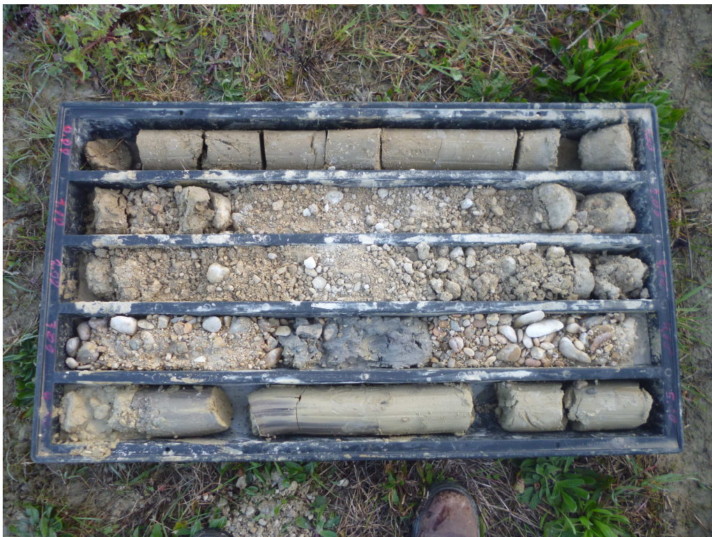
Foto n°2 – Sondaggio n°10: Cassetta n°1 da 0.00 a -5.00 m
