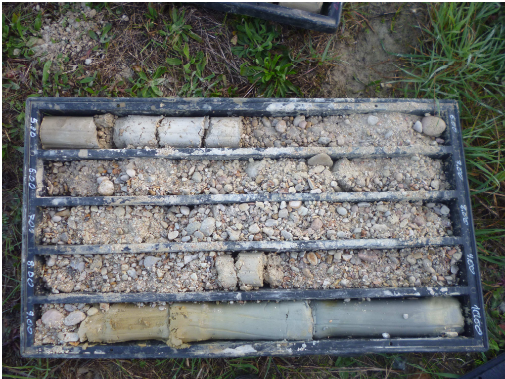
Foto n°3 – Sondaggio n°10: Cassetta n°2 da -5.00 a -10.00 m
