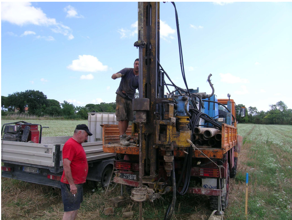
Foto n°38- Prova Penetrometrica SPT in foro di sondaggio (da 3,00m a - 3,50m)
