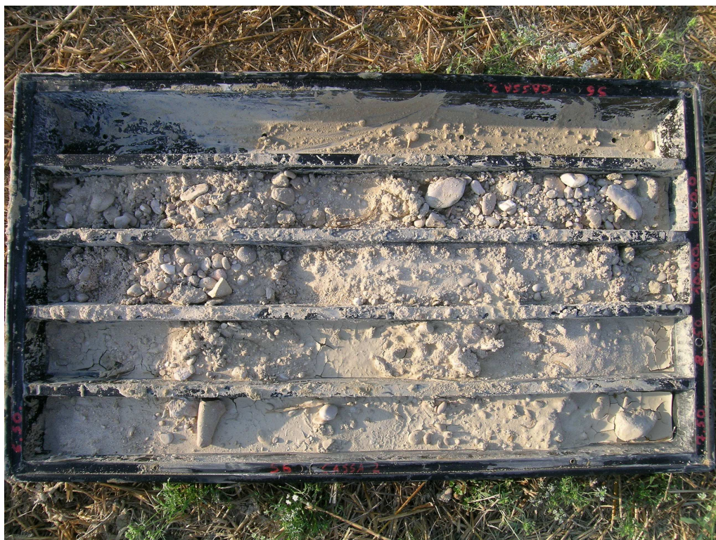
Foto n°26 – Cassetta n°2, Sondaggio n°6: Materiali estratti da -6.50m a -12.00m
