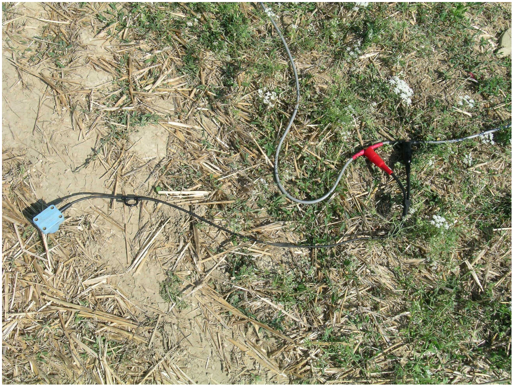
Foto n°45: Particolare del geofono
