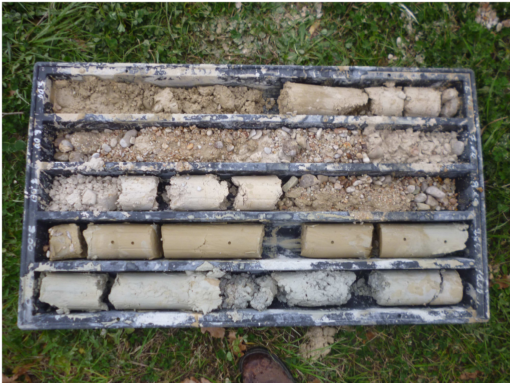
Foto n°9 – Sondaggio n°12: Cassetta n°2 da -5.00 a -10.00 m
