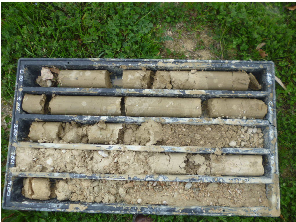
Foto n°8 – Sondaggio n°12: Casseta n°1 da 0.00 a -5.00 m
