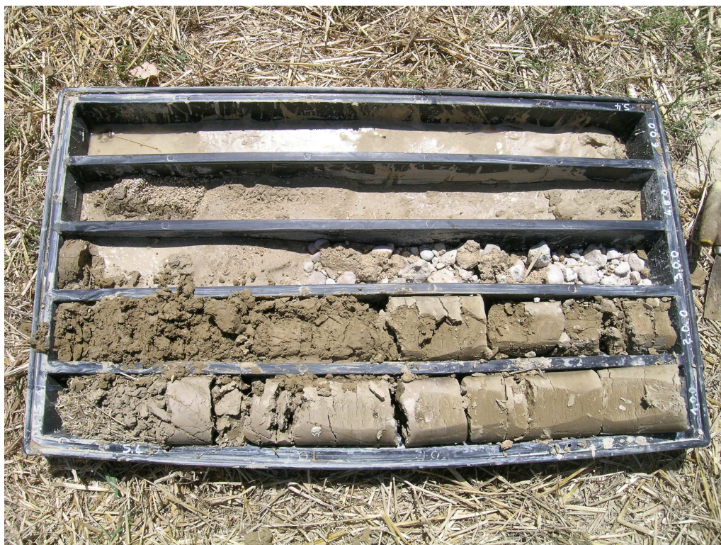
Foto n°25 – Cassetta n°2 Sondaggio n°6: Materiali estratti da 0.00m a -6.50m
