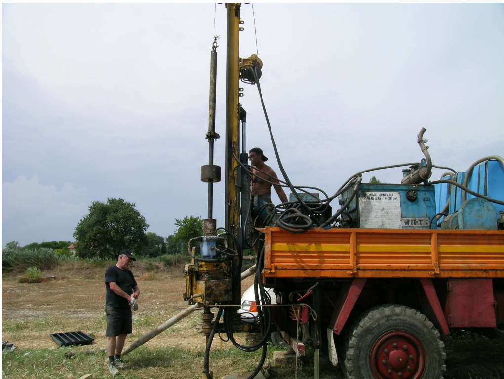
Foto n°34- Prova Penetrometrica SPT in foro di sondaggio da 3.00m a -3.50m
