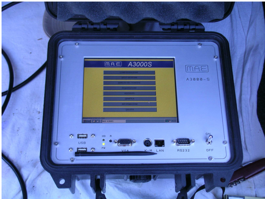
Foto n°46- Acquisitore di segnale
