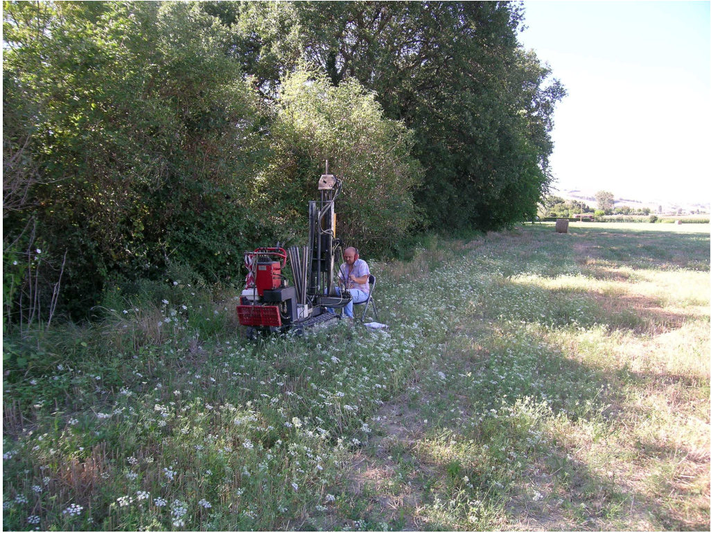
Foto n°47 - Postazione Prova penetrometrica dinamica n°2
