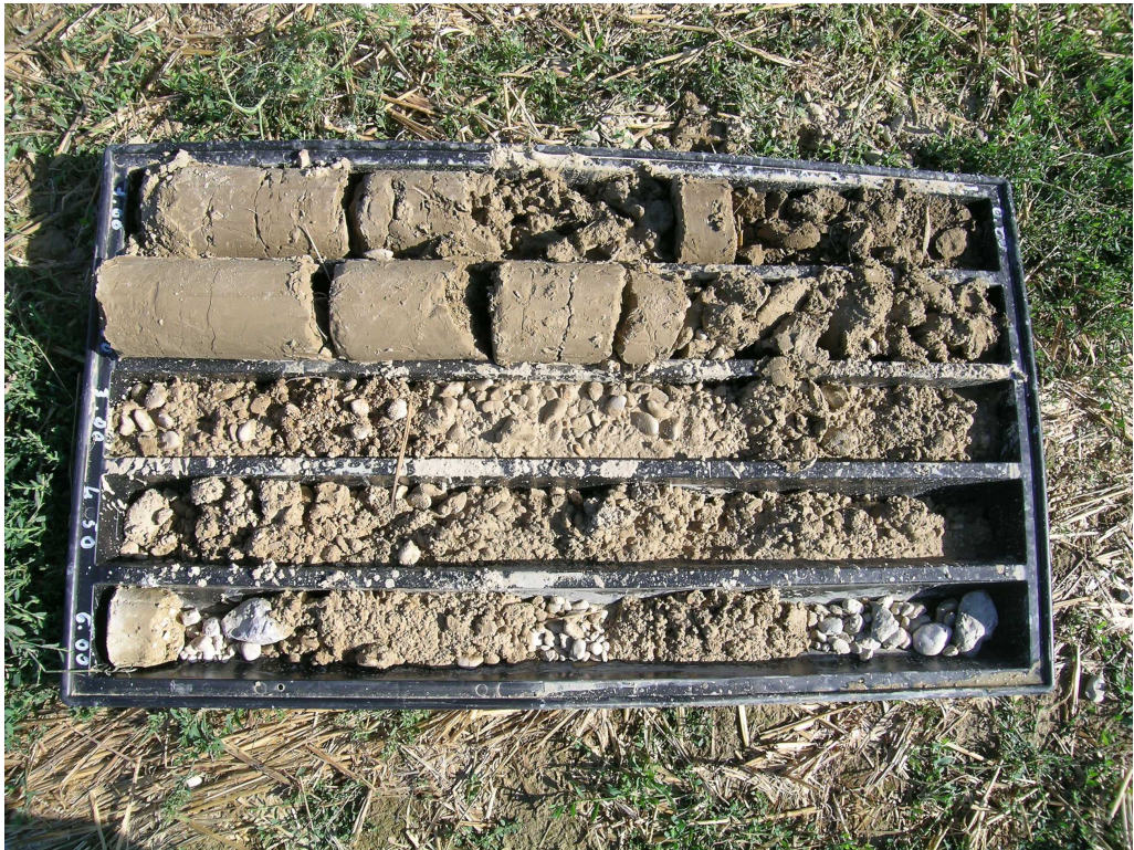
Foto n°35: Cassetta n°1 Sondaggio n°7: Materiali estratti da 0.00m a -6.00m
