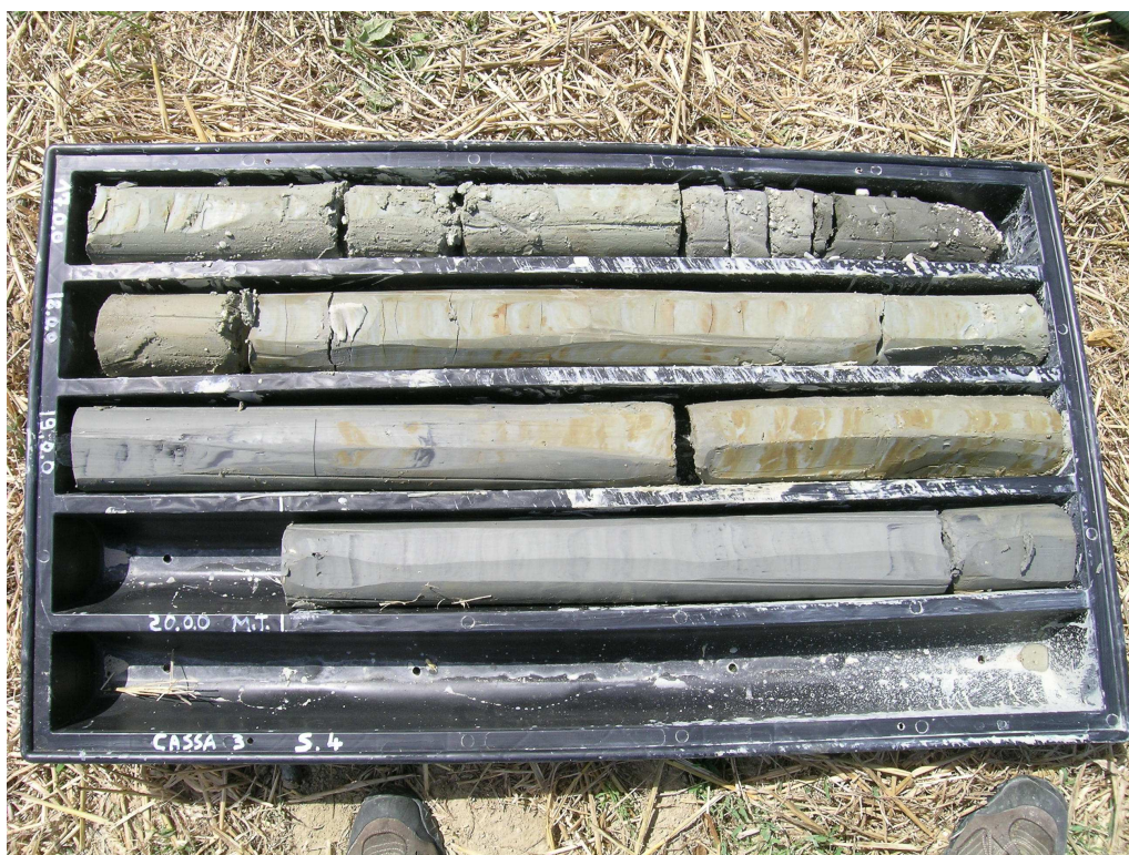
Foto n°8 – Sondaggio n°4, Cassetta n°3: materiali estratti da -16,00m a -20,00m
