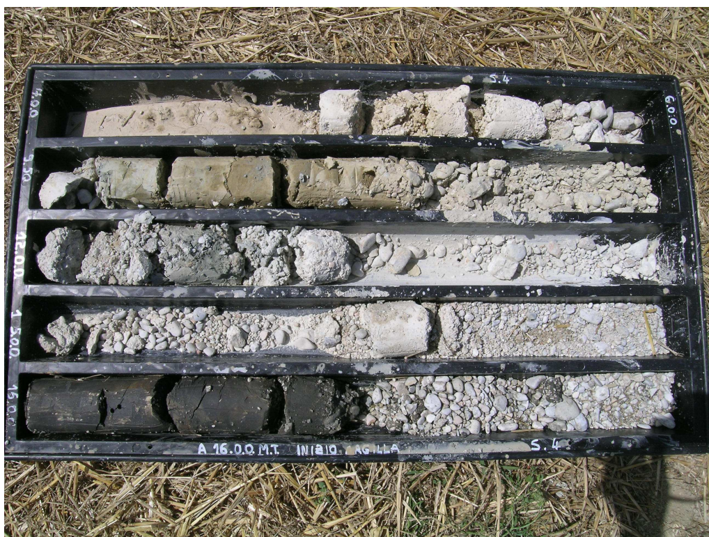
Foto n°7 – Sondaggio n°4, Cassetta n°2: Materiali estratti da 6,00m a -16,00m
