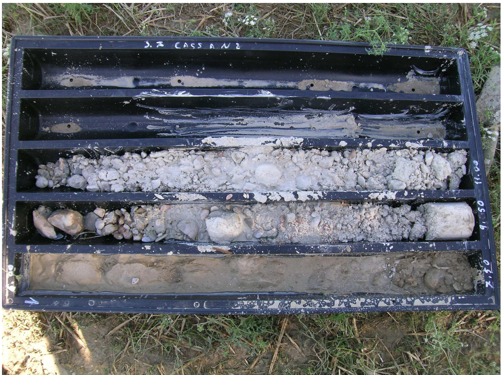
Foto n°36- Cassetta n°2 Sondaggio n°7: Materiali estratti da -6.00m a -11.00m
