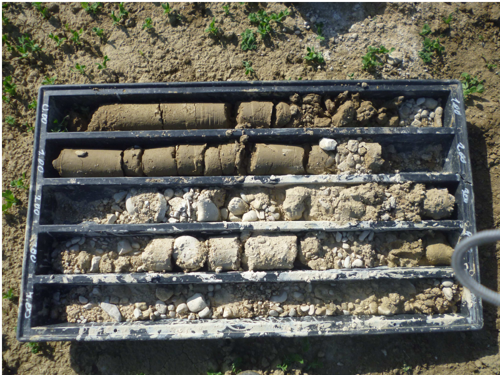
Foto n°5 – Sondaggio n°11: Cassetta n°1 da 0.00 a -5.00 m
