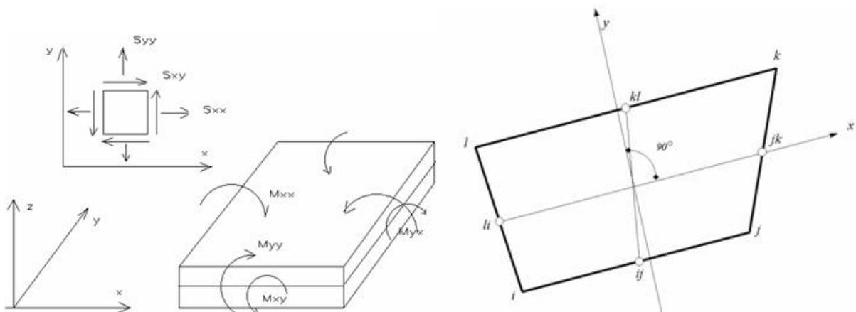
La terna locale per l'elemento shell è costituita dall'asse x locale che va dal nodo li al nodo jk, l'asse y è diretto secondo il piano dell'elemento e orientato verso il nodo l e l'asse z di conseguenza in modo da formare la solita terna sinistrorsa. L'asse z locale rappresenta la normale positiva all'elemento.
