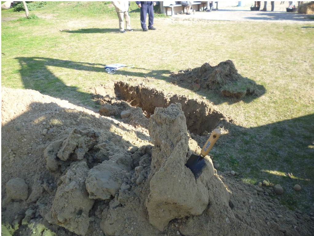
Foto n°13 – Panoramica postazione scavo n°sa4 (Pratone centro – Hotel Royal) – Particolare dei materiali estratti dallo scavo: sabbie di litorale
