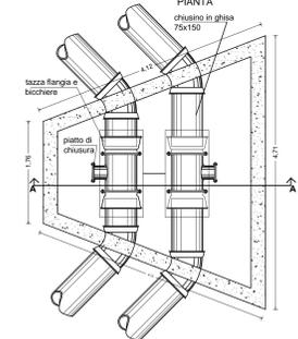
**POZZETTO D'ISPEZIONE E PULIZIA IN LINEA**
