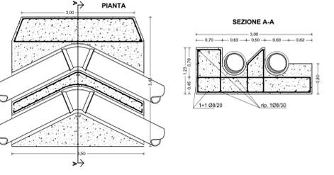
**POZZETTO D'ISPEZIONE E PULIZIA IN LINEA**
