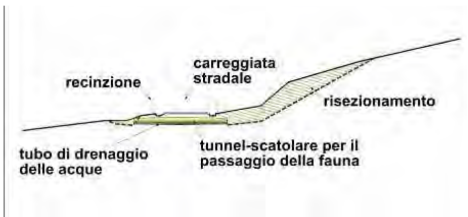
Figura 3 – Schema tipo di risezionamento del versante per garantire un accesso agevole al tubo/scatolare per il passaggio della fauna. Vista in profilo/sezione.
