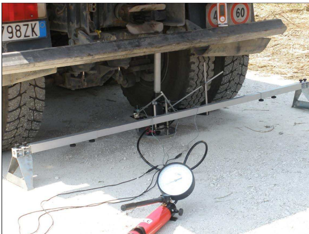
Figura 1 –Particolare esemplificativo disposizione apparecchiatura di prova per la determinazione di M_d
